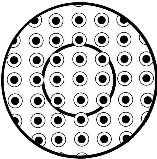
Solenoid visto de frente. La espira se encuentra en el centro. Se observa cómo la espira es atravesada sólo por parte del campo magnético generado por el solenoide.
