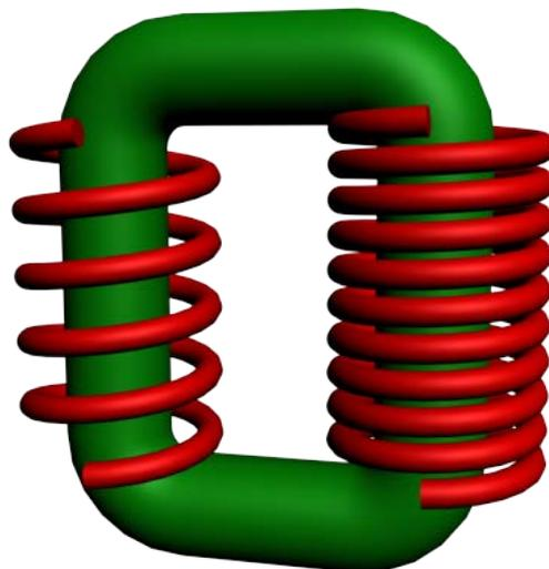
Un transformador eléctrico es un dispositivo que se utiliza para convertir un voltaje en otro. Se utiliza, por ejemplo, para transformar 220 voltios en 125 voltios o viceversa.
